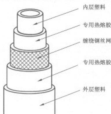
图 1 管材结构图
